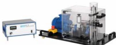
En génie mécanique, les commandes à came jouent un rôle important pour la transformation du mouvement rotatif en mouvement oscillant.
