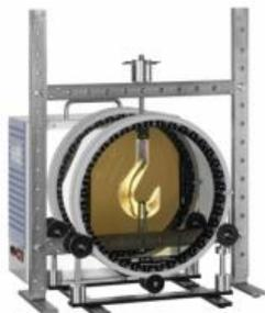
La photoélasticimétrie est une méthode éprouvée d'analyse et d'enregistrement des contraintes mécaniques dans les composants.
