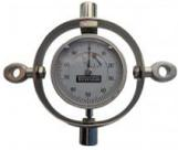
Avec ce dynamomètre universel, les forces de traction ou de compression peuvent être mesurées en fonction de la position de montage.
