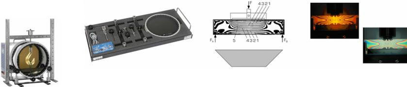
La photoélasticimétrie est une méthode éprouvée d'analyse et d'enregistrement des contraintes mécaniques dans les composants.
