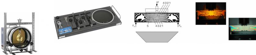
La photoélasticimétrie est une méthode éprouvée d'analyse et d'enregistrement des contraintes mécaniques dans les composants.
