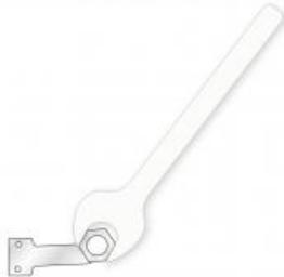
Ce modèle est utilisé pour représenter des gradients de stress sous pression. Le modèle est disponible comme accessoire pour FL 200 Essais photoélastiques à l'aide d'un polariscope par transmission.
