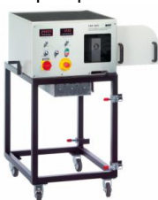
1 élément d'affichage et de commande, 2 broche du dispositif de tension de la courroie trapézoïdale, 3 résistance de charge, 4 terminal à genouillère, 5 levier de blocage du dispositif de tension, 6 trappe de service transparente, 7 site de projection de la courroie trapézoïdale
