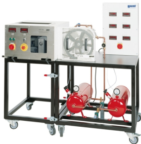
1 compresseur, 2 poulie de courroie, 3 réservoir d'aspiration, 4 soupape de purge avec silencieux, 5 soupape de sécurité, 6 réservoir sous pression, 7 pressostat, 8 électrovanne, 9 armoire de commande avec affichages numérique
