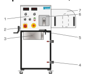
1 élément d'affichage et de commande, 2 broche du dispositif de tension de la courroie trapézoïdale, 3 résistance de charge, 4 terminal à genouillère, 5 levier de blocage du dispositif de tension, 6 trappe de service transparente, 7 site de projection de la courroie trapézoïdale
