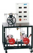
1 compresseur, 2 probe de courant, 3 réservoir d'aspiration, 4 soupape de purge avec siphonneur, 5 soupape de sécurité, 6 réservoir auxiliaire, 7 fréquence, 8 électrovanne, 9 armoire de commande avec affichages numérique
