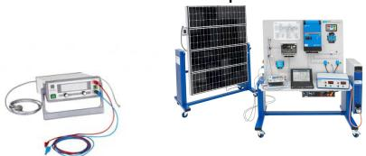
L'ET 255.01 avec l'ET 255 permet de simuler les caractéristiques de courant et de tension des modules photovoltaïques.
