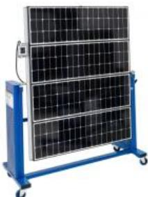
**Comportement en fonction des variations de température, d'éclairement avec solaire, lumineuse HL313.**
