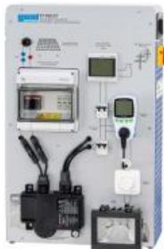
Différents composants de l'installation sont requis pour l'alimentation d'un réseau électrique public en électricité solaire.
