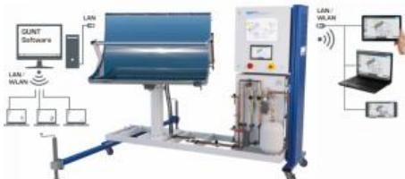
Les capteurs cylindro-paraboliques sont constitués de surfaces miroirs de forme parabolique dans lesquelles le rayonnement solaire est collecté et concentré dans un absorbeur.
