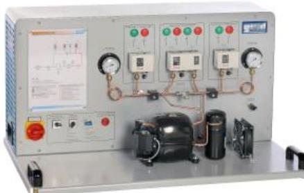
Il est possible de démontrer le fonctionnement de ce qu'on appelle les pressostats utilisés en génie frigorifique à l'aide de cet appareil d'essai.
