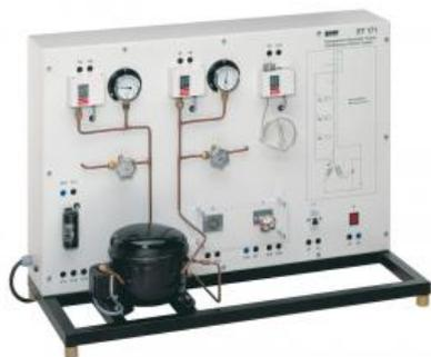
La circuiterie des composants électriques pour le démarrage et le fonctionnement de compresseurs d'agent réfrigérant est une tâche typique du génie frigorifique.
