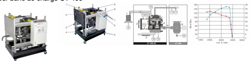
Le moteur CT 400.02, associé à l'unité de charge CT 400, forme un banc dessai pour moteurs complets.
