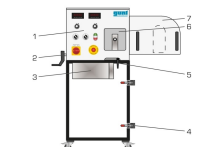
1 élément d'entraînement et de commande, 2 broche de dispositif de freinage de la courroie trapézoïdale, 3 résistance de charge, 4 fermeture à genouillère, 5 bride de montage du dispositif de freinage, 6 trappe de service transparente, 7 tête de protection de la courroie trapézoïdale
