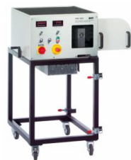
1 élément d'entraînement et de commande, 2 broche de dispositif de freinage de la courroie trapézoïdale, 3 résistance de charge, 4 fermeture à genouillère, 5 bride de montage du dispositif de freinage, 6 trappe de service transparente, 7 tête de protection de la courroie trapézoïdale
