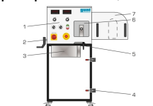
1 élément d'affichage et de commande, 2 broche du dispositif de tension de la courroie trapézoïdale, 3 valance de flux, 4 interrupteur à genouillère, 5 servit de réglage du dispositif de tension, 6 réglage de service transparent, 7 tôle de protection de la courroie trapézoïdale
