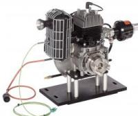
En combinaison avec le banc dessai CT 110, qui renferme une unité de freinage et dentraînement, le moteur essence deux temps convient parfaitement à lenseignement des principes de base du fonctionnement et de la technique de mesure sur moteurs.
