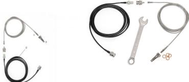
Pour les essais avec indication de pression dans le cylindre sur le moteur de test CT 100.23, le moteur est doté d'un capteur de pression miniature.
