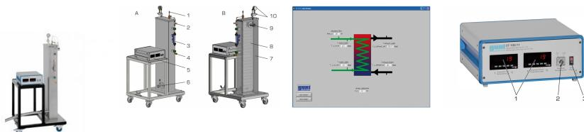
La détermination des pertes thermiques des gaz déchappement est nécessaire pour effectuer le bilan énergétique des moteurs à combustion interne.
