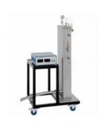
La détermination des pertes thermiques des gaz déchappement est nécessaire pour effectuer le bilan énergétique des moteurs à combustion interne.
