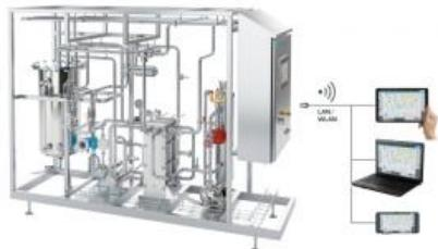
La pasteurisation est un procédé qui permet de conserver des aliments tels que le lait, la bière et les jus de fruits. Le produit est chauffé à une température définie et maintenu à cette température pendant un temps défini.
