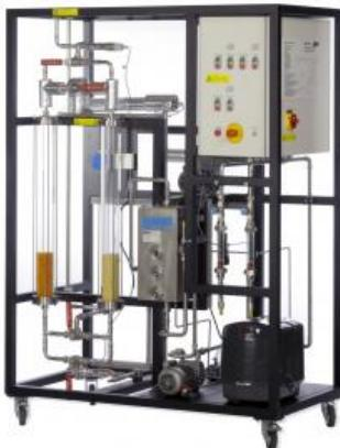
Le CE 540 permet d'expliquer clairement les bases théoriques complexes des processus d'adsorption à l'aide de dessais. Un compresseur aspire l'air ambiant.
