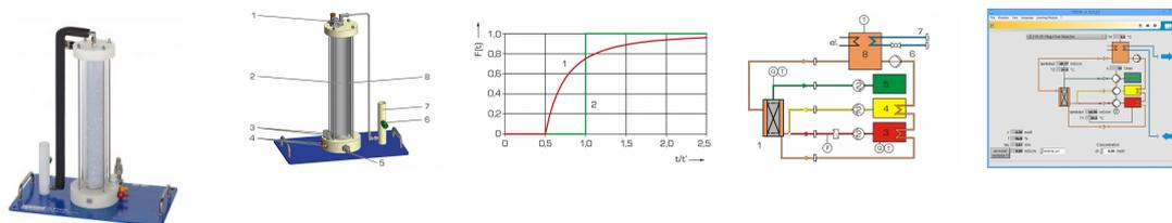
Les réacteurs à écoulement piston sont des réacteurs à écoulement tubulaire et fonctionnent en continu. Ils permettent l'étude de réactions chimiques dans des conditions définies.
