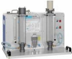
Lorsque des couches de particules solides sont traversées par des liquides ou des gaz et que le lit fixe se relâche à tel point que les particules solides peuvent se déplacer librement, le lit fixe passe à l'état de lit fluidisé.
